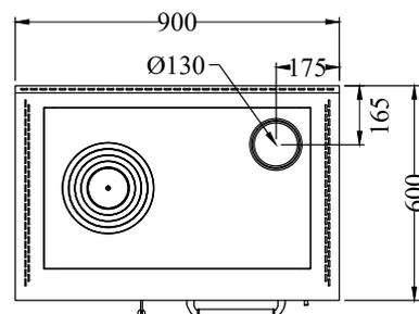
Version avec sortie de fumées à droite. La version avec sortie de fumées à gauche est symétrique.
